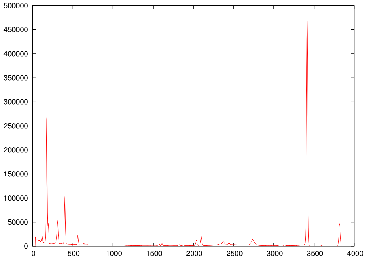
Abbildung 13: Spektrum der Cobalt-Quelle (Counts gegen Channels)
